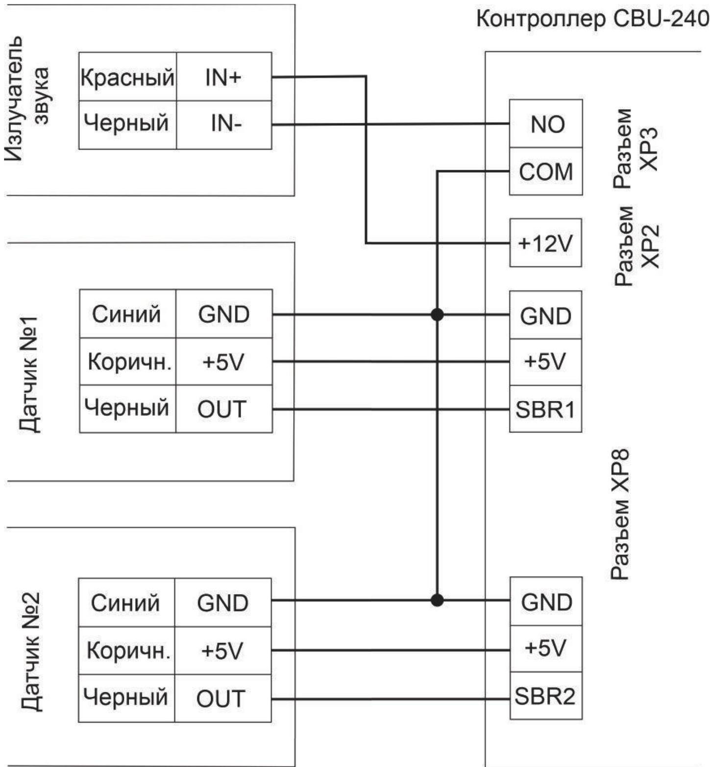
Рисунок 6.7.3 Схема подключения модуля датчика несанкционированного прохода
